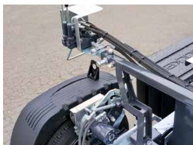
De wielaandrijving (optioneel) d.m.v. tandrad
