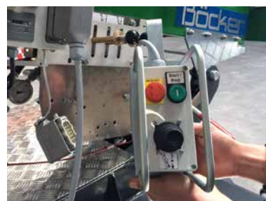
Bediening van de slede door elektrische Joy-stick
