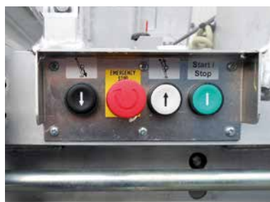
Automatische bediening onder / boven met vertraagde start en stop
