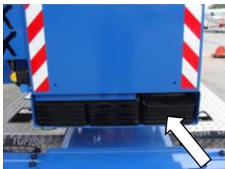
Afb. 7-3 Steun voor contragewichtsplaten
