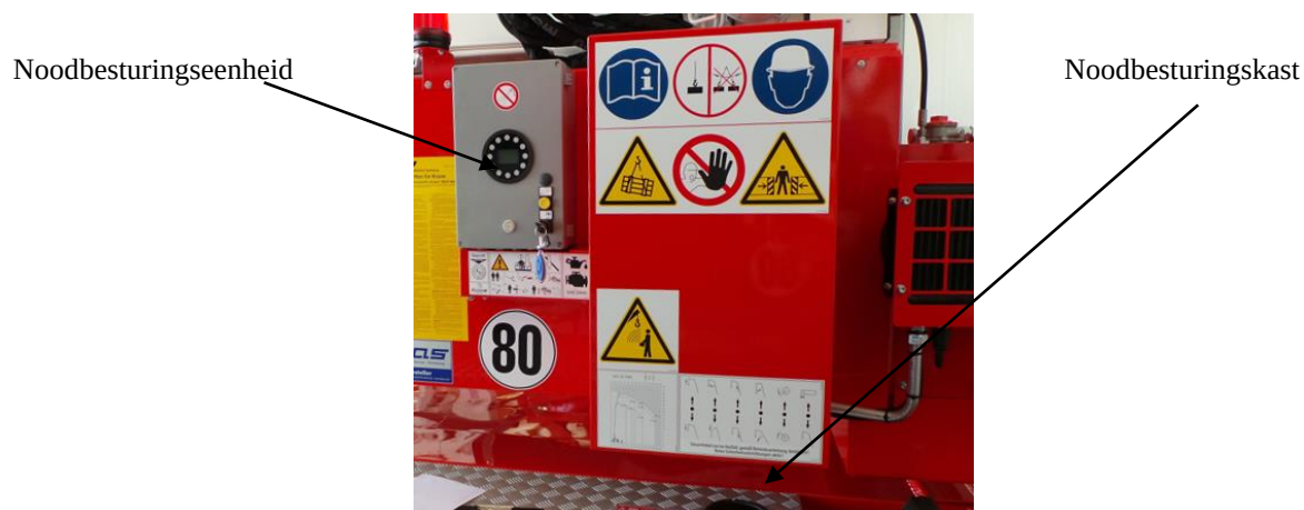
Afb. 12-3 Noodbesturingskast met aanduidingsborden en functiediagram
